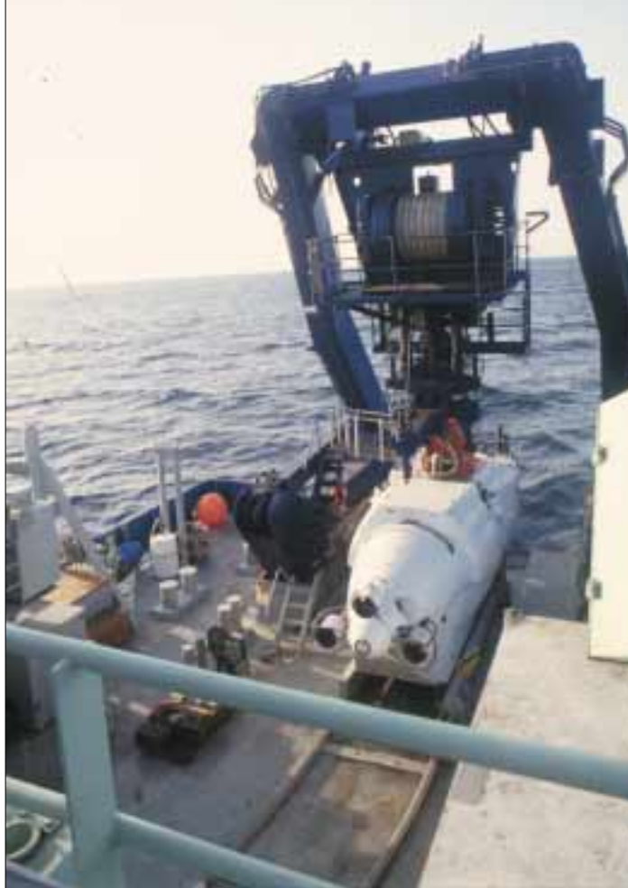
Forskningssubåden Alvin, der drives af Woods Hole Oceanographic Institute i USA. Alvin bruges til at samle sedimenter i Guaymas Bassinet i Den californiske Golf på ca. 2,5 kilometers dybde.
